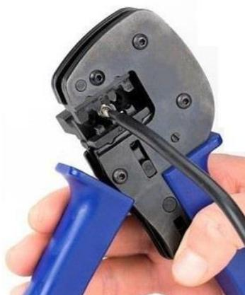
**FIGURA 30 - UTILIZAÇÃO DO ALICATE "CRIMPADOR" PARA UNIR O TERMINAL DO CONECTOR MC4 AO CABO.**
