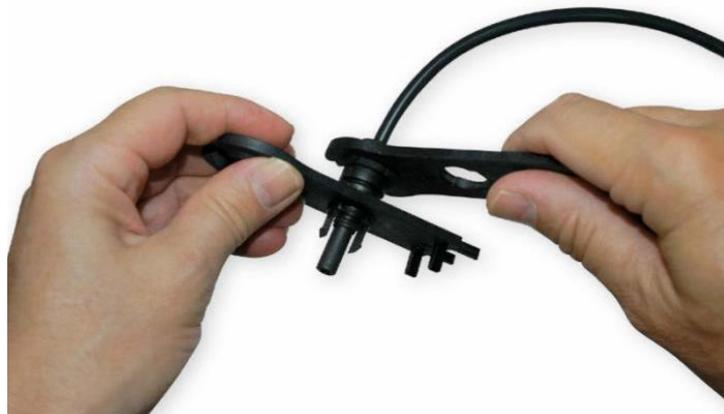
**FIGURA 32 - FORMA ADEQUADA DE APERTAR A TAMPA DE VEDAÇÃO DOS CONECTORES MC4.**
