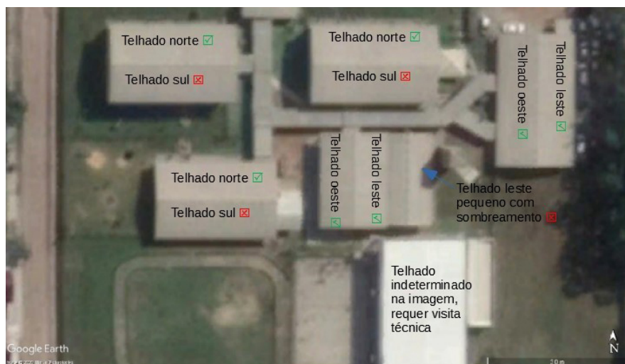
Figura 5. Avaliação qualitativa dos telhados de uma escola. Fonte: Google Earth, 2020.
